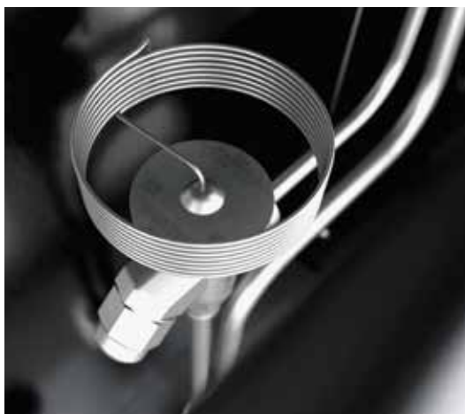
Valvola termostatica meccanica di serie
